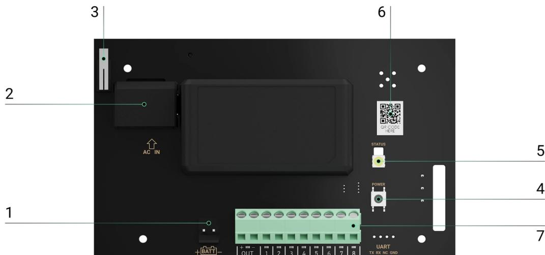
1. Клеммы для подключения резервного аккумулятора 12 В $\equiv$ .
