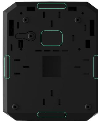
4. Закрепите корпус на вертикальной поверхности в выбранном месте установки с помощью комплектных шурупов. В процессе крепления используйте все точки фиксации, присутствующие на корпусе. Одна из них, в перфорированной части крепления над тампером, нужна для срабатывания тампера на задней части платы в случае попытки отрыва корпуса от поверхности.
