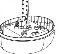
Il est possible d'orienter la direction de la lumière Led en changeant la position de la carte à l'intérieur de la lampe clignotante.
