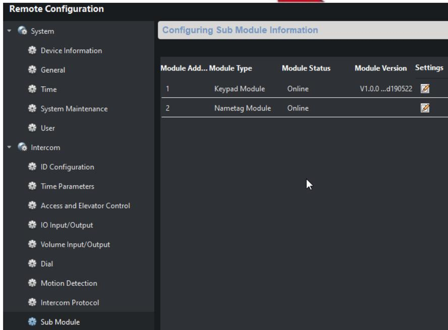
Modul tipkovnice smo konfigurirali kad smo dodijelili šifru za otvaranje vrata. Da bi konfigurirali modul sa pozivnim tipkama, kliknite na **Settings** ikonu te birate koja tipka će pozivati koji stan (odnosno broj sobe unutarne jedinice):
