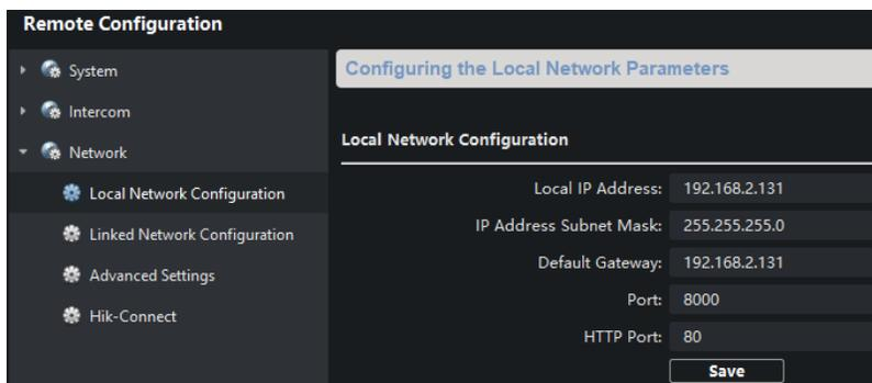
Pod **Linked Network Configuration** > **(Main) Door Station IP Address** upisujete adresu vanjske jedinice sa kojom povezujete unutarnju jedinicu:
