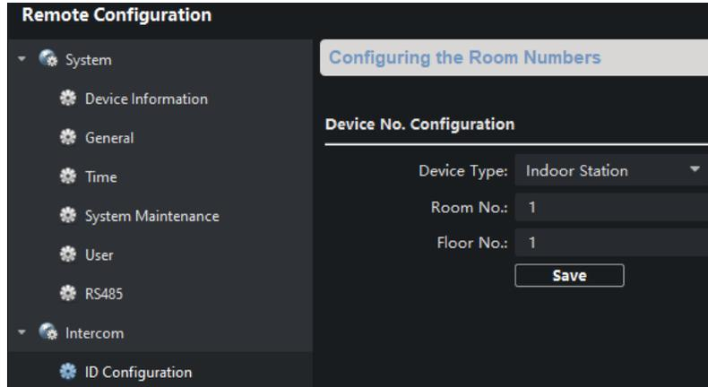
Ako želite da poziv sa vanjske jedinice istovremeno dolazi na dvije (ili više) unutarnje jedinice, jednu unutarnju jedinicu morate postaviti kao Master, drugu kao Slave. Za Master pod **Device Type** ostaviti **Indoor Station**, za Slave postaviti **Station Extension** i broj 1 za prvu Slave jedinicu, 2 za drugu, itd. **Maksimalno 5 unutarnjih jedinica možete postaviti kao ekstenziju.**
