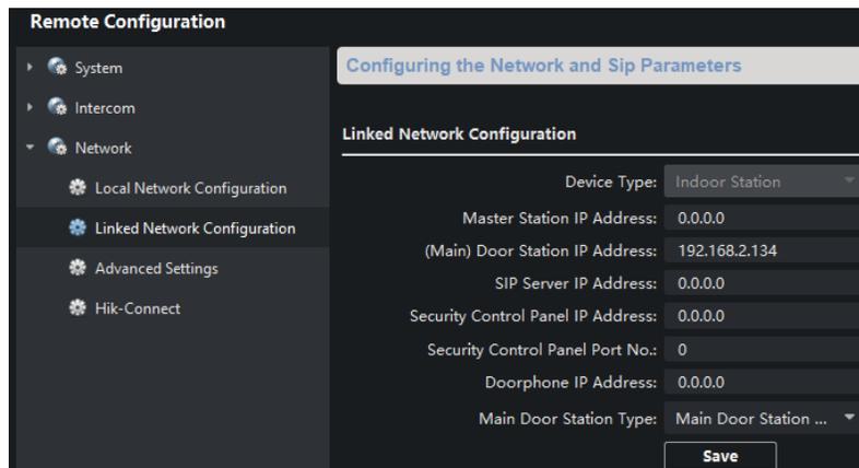
U slučaju da vam unutarnja jedinica služi kao ekstenzija drugoj unutarnjoj jedinici, pod **Linked Network Configuration** upisujete IP adresu Master unutarnje jedinice:
